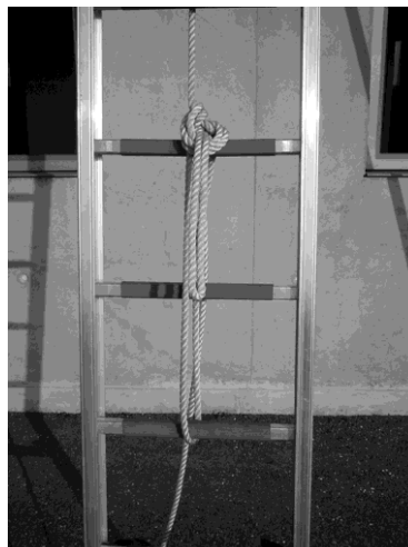
mind. 3 Sprossen Mastwurf mit Spierenstich Zugseil auf Span- nung!
